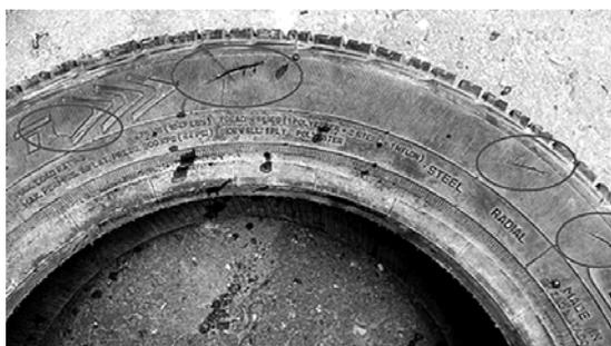
Рис. 10. Шина с трещинами на боковой поверхности, выделенными на фотографии овалами. В данной шине износ протектора допускает ее дальнейшую эксплуатацию
