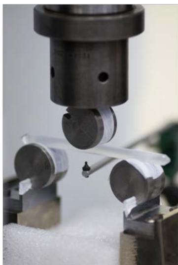
Рис. 5. Испытание силового стержня на трехточечный изгиб
