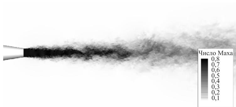
Рис. 7. Распределение числа Маха в осевом сечении сопла JEAN в момент времени  $t = 0,1$  с
