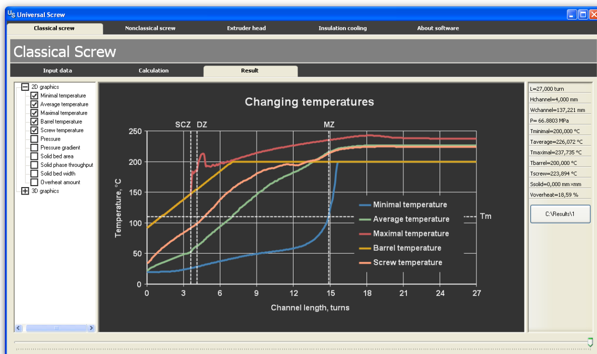
Рис. 9. Распределение температур по длине канала экструдера
