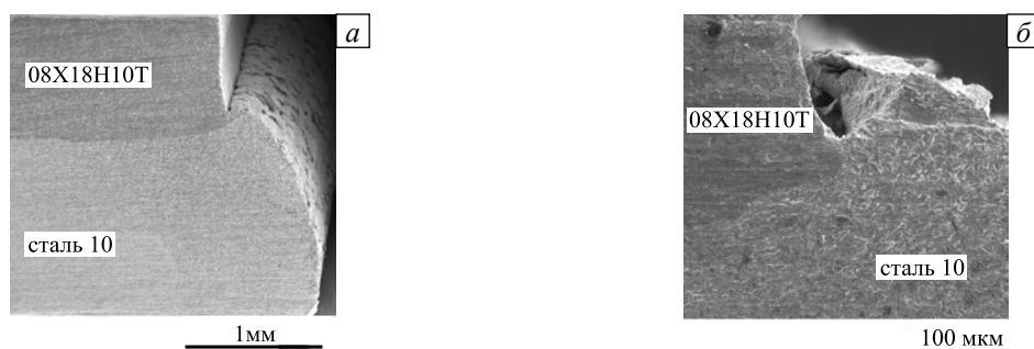
Рис. 11. Вид боковой поверхности и поперечного сечения образцов после 6-го прохода прокатки при разном увеличении
