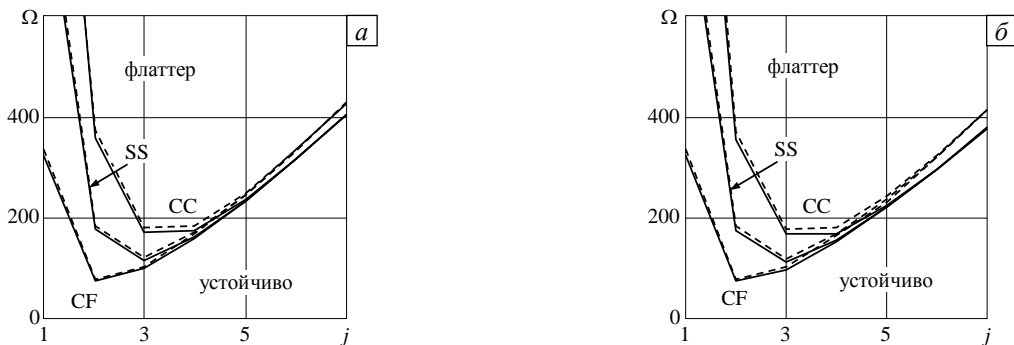
Рис. 3. Зависимости критических угловых скоростей вращения жидкости \Omega (рад/с) в кольцевом (сплошные линии) и внутреннем (пунктирные линии) потоках от номера гармоники j для коаксиальных оболочек с различными граничными условиями с жесткой (а) и упругой (б) внешней оболочкой; k = 1/10
