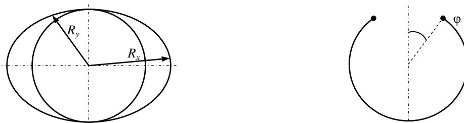
Рис. 3. Основные параметры сечений эллиптической (а) и открытой (б) оболочек
