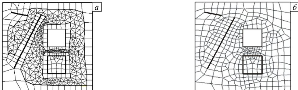
Рис. 3. Область «Б». Фронты перестроения в алгоритме QMM (а) и перестроенная с его помощью сетка четырехугольных элементов со структурными ребрами (б)
