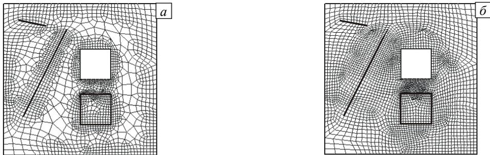
Рис. 5. Сетка «Б» после перестроения четырехугольников с «защищенными» ребрами (а) и после перестроения всех ячеек (б)
