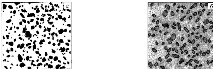
Рис. 6. Структура материала: реальная (а) – микрошлиф ( $205 \times 180 \mu\text{м}$ ) материала Al-Si-Mg с включениями Si, и расчётная (б) – перестроенная сетка модельной области, содержащей 97 включений
