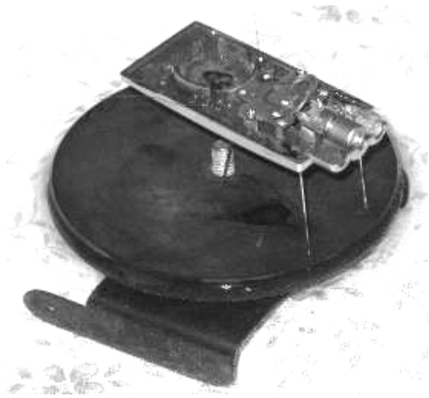
Рис. 3. Образец на подставке с источником лазерного излучения
