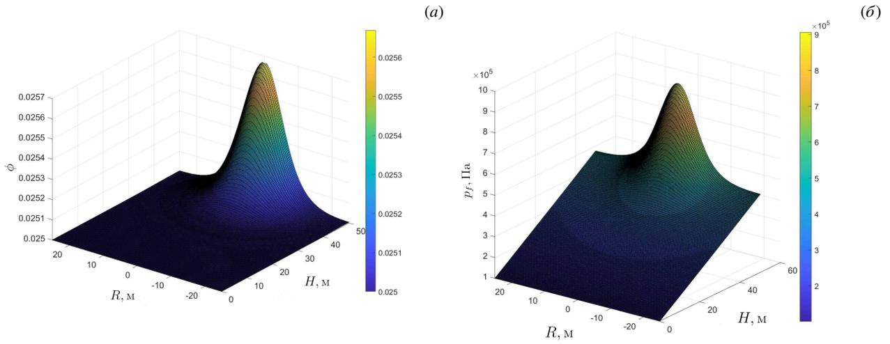
Рис. 3. Вариант А: пористость (а) и давление газа (б) на момент времени 8 сут
