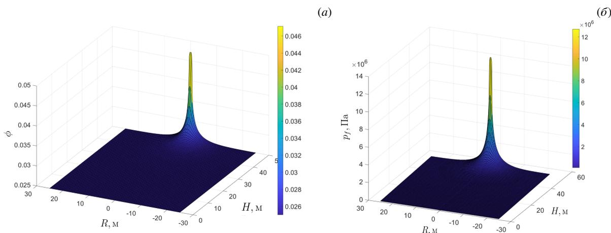
**Рис. 2.** Вариант А: распределения пористости (а) и давления газа (б) на момент остановки закачки (через 7 сут)
