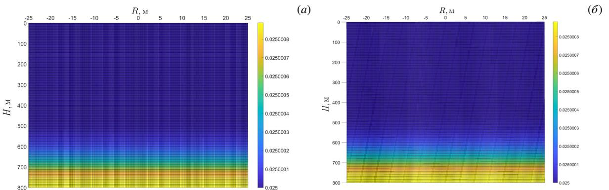
Рис. 8. Вариант нагнетания *C*: пористость спустя 180 дней (а) и спустя 1 год (б) после остановки закачки
