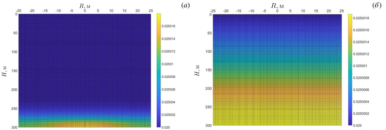
Рис. 6. Вариант нагнетания *B*: пористость на 8-е сут (а) и спустя 1 год (б) после остановки закачки
