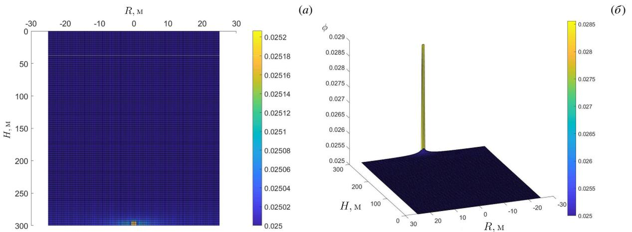
Рис. 5. Вариант нагнетания В: пористость на момент остановки закачки (через 7 сут)
