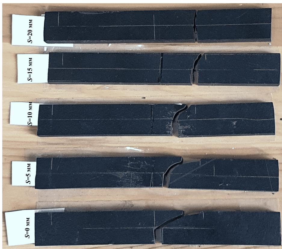
Рис. 8. Разрушенные образцы из эбонита
