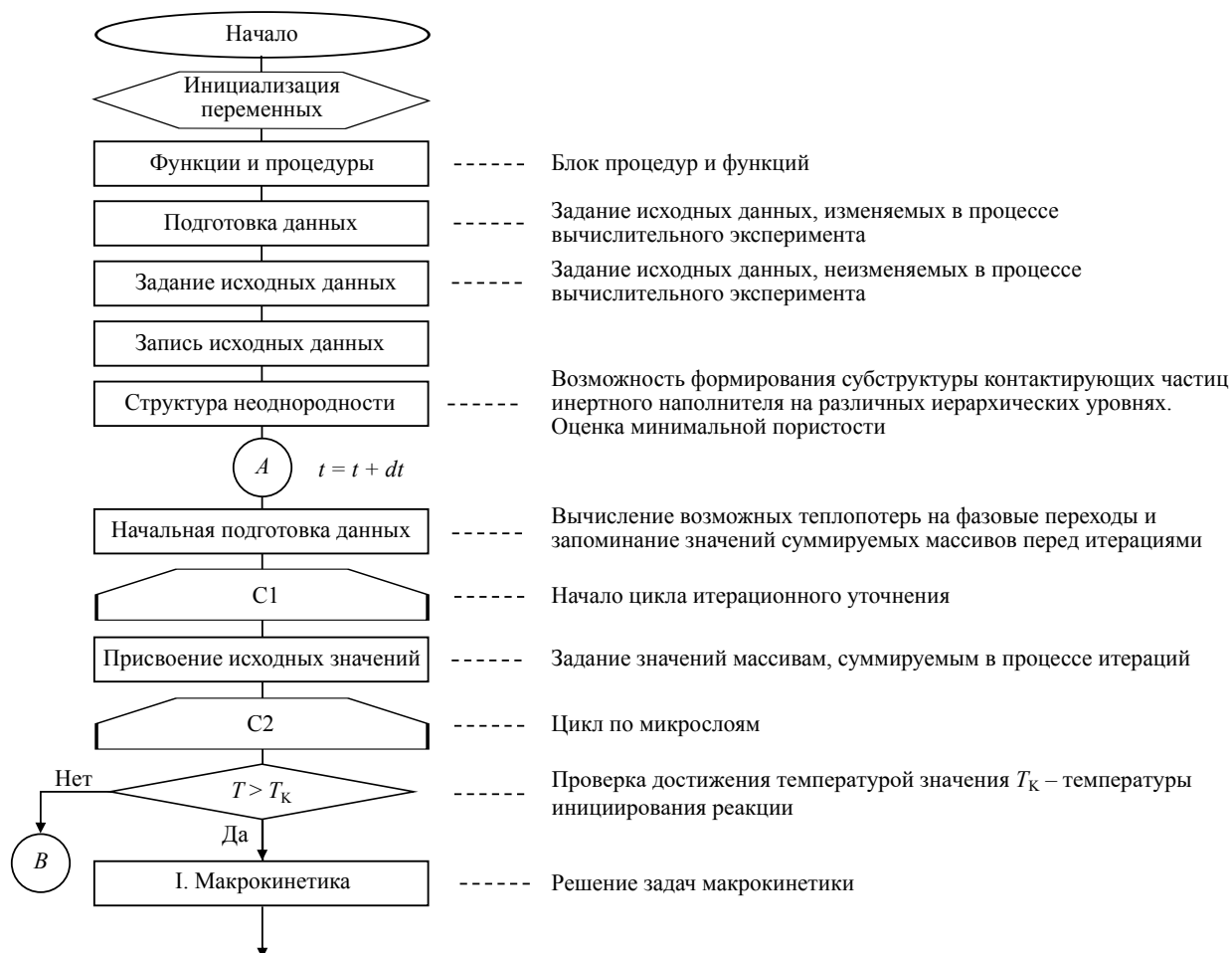
Рис. 2. Блок-схема алгоритма решения связанной задачи оценки прочности цементной полифракционной системы
