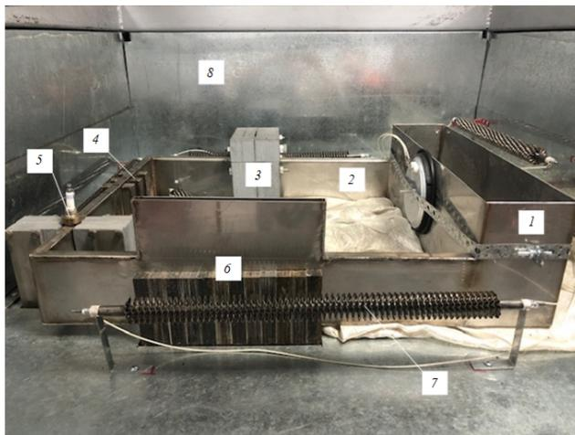
**Рис. 1.** Фотография оловянно-свинцового контура в сборе: 1 – бак, 2 – канал, 3 – трансформатор тока, 4 – кондукционный насос, 5 – кондукционный расходомер, 6 – сепарационная ячейка под слоем сердечников, 7 – электронагреватели, 8 – теплоизоляция
