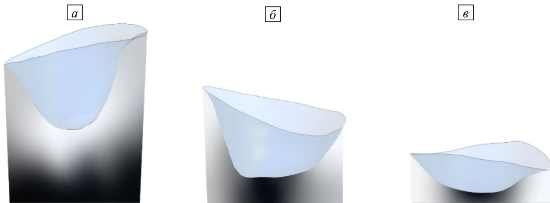
Рис. 3. Плотность распределения дисперсной фазы (частиц диаметром 3 мкм); жидкий металл занимает от первоначального объема, [%]: 100 (а), 50 (б), 25 (в)
