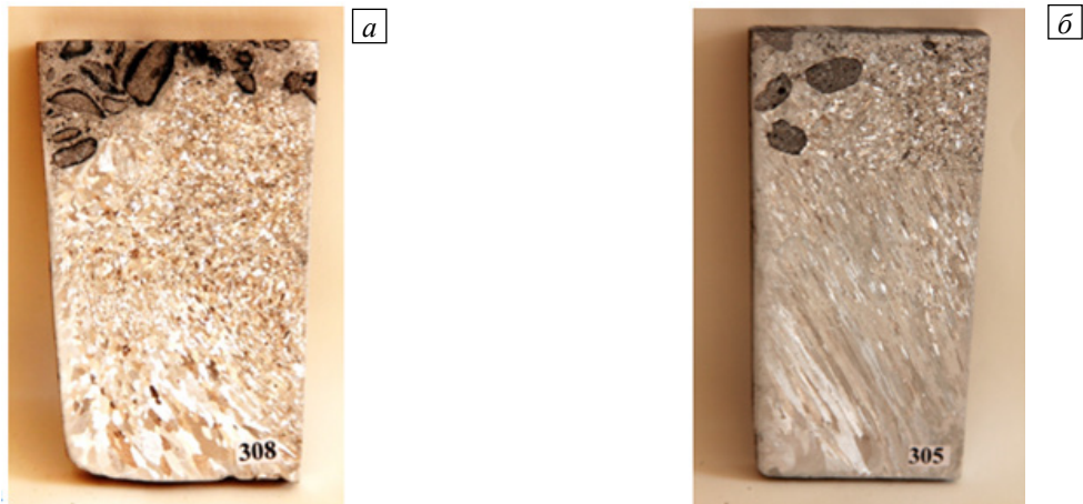
Рис. 5. Левая половина продольного сечения алюминие слитков с введенными микрочастицами TiB_2 ; результирующая концентрация микрочастиц оценивается, [%]: 3,1 (а), 2,5 (б); в верхних частях слитков видны части нерастворившихся таблеток; наблюдается уменьшение размеров зерна в структуре слитка круглого сечения при увеличении расстояния от дна до поверхности
