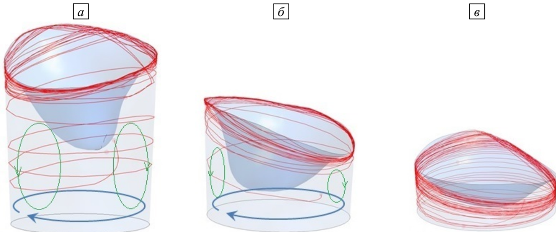
Рис. 2. Траектории частиц диаметрами, [мм]: 10 (а), 7.5 (б), 5 (в) через 20 с после начала движения; жидкий металл занимает, соответственно, 100, 50, 25% от первоначального объема; линиями со стрелками показано направление движения расплава, тонкая линия – траектория частицы в расплаве
