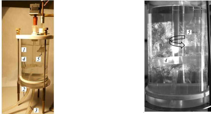
Рис. 1. Действующий проточный кристаллизатор (а): 1 – контейнер; 2, 3 – трубки для втекания и вытекания раствора; 4 – мешалка; 5 – кристалл; визуализированное течение (б) при реверсивном вращении мешалки со скоростью 1,57 рад/с
