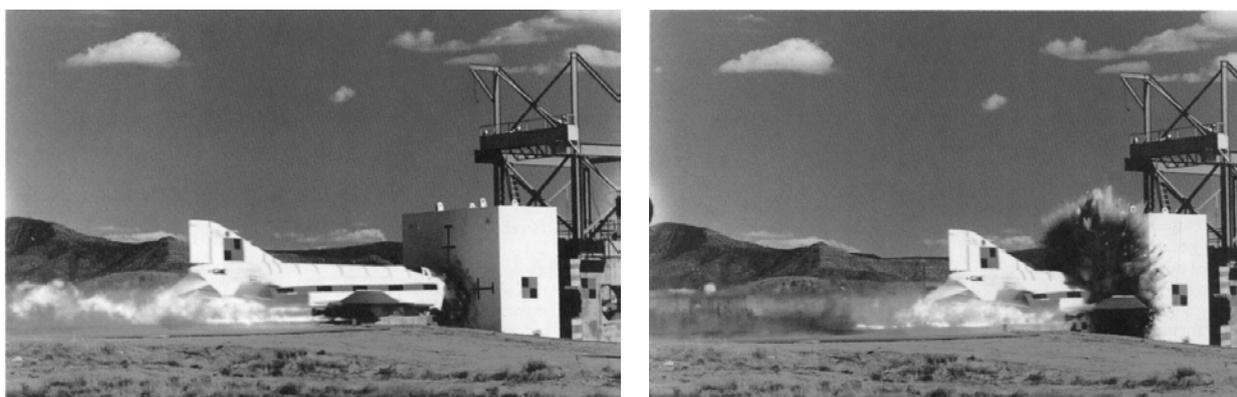
Рис. 10. Удар самолёта F-4 Phantom в железобетонную преграду [14]
