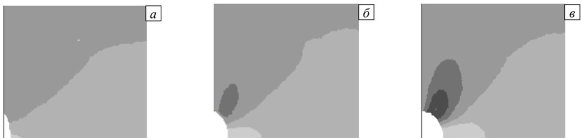
Рис. 7. Распределение касательных напряжений  $\tau_{xy}$  в 1/4 части пластины
