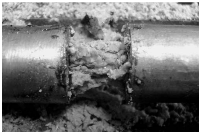
Рис. 8. Фотография разрушенного образца после его ударного нагружения на стержне Гопкинсона–Кольского [10] (третья мода разрушения)
